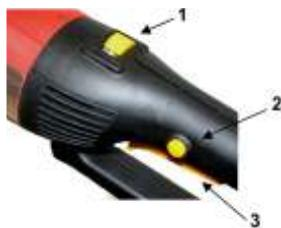
9. Após posicionar a seta para traz, acione novamente o gatilho de acionamento (3) e o botão auxiliar lateral (2) e aguarde até a máquina voltar na posição inicial e ser removida do tubo, em seguida, solte o gatilho de acionamento (3).
