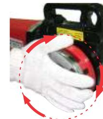
7. **NÃO INTERROMPA A OPERAÇÃO ATÉ O TUBO FACEAR O CABEÇOTE OU PREENCHER OS COSSINETES**, até que a operação de rosca seja finalizada lubrifique constantemente com óleo ROSCA/CORTE para que os cossinetes sejam refrigerados.
