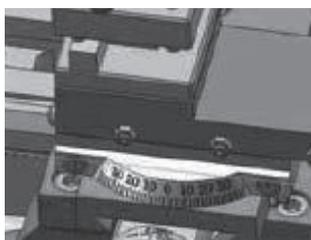
O carro porta ferramentas possui a opção de trabalho em grau, com regulagem de 0 a 45° a precisão mostrada na placa de dial sobre a manivela deve ser de 0,002mm.
