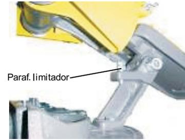
**ATENÇÃO:** Antes de colocar em funcionamento a sua serra de corte rápido F-12 A, deve-se regular a profundidade de corte. Para isso, basta girar o parafuso indicado na figura acima. Execute com a máquina desligada.
