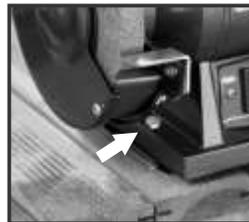
Fig. 6 – Fixação em bancada
