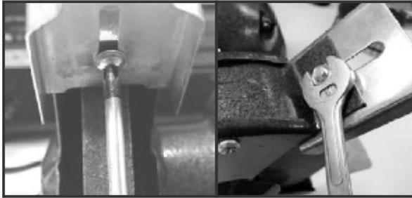
Fig. 2 – Montagem do Protetor visual
