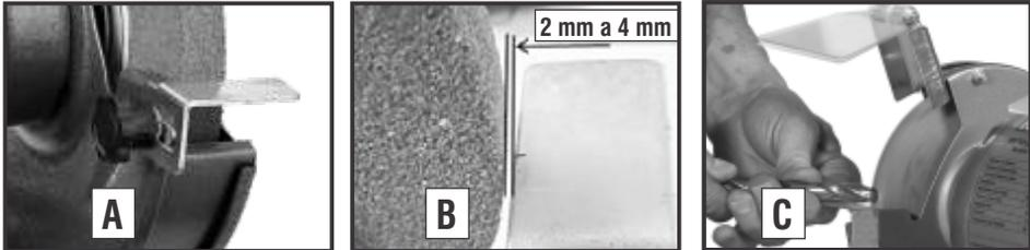
Fig. 4 – Regulagem da mesa de apoio da peça
